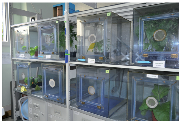
Figure 2. Vue d'ensemble d'une partie des rayonnages sur lesquels sont entreposées les cages d'élevage de pucerons. Les tablettes supérieures sont en PVC ce qui permet de laisser passer la lumière sur les cages situées en-dessous (photo : M.A Dome).
