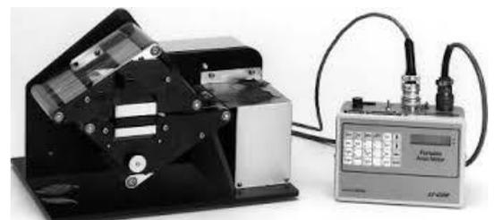
Figure 4 : Planimètre portable Li-3000 A
