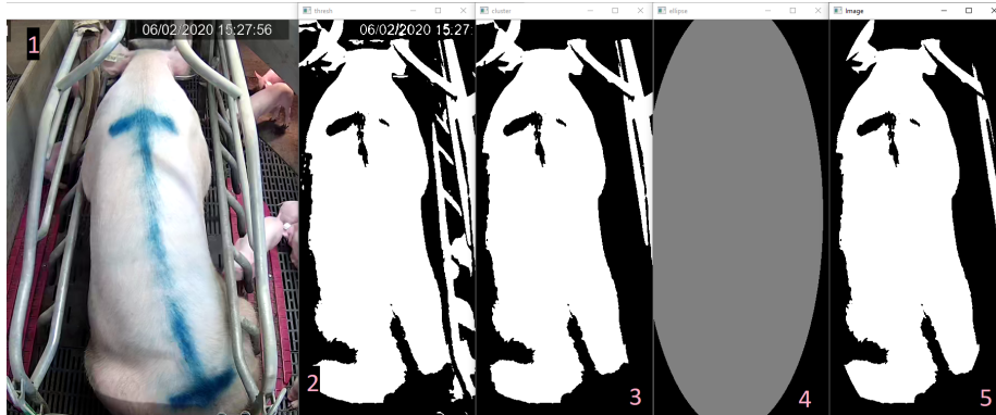
FIGURE 5: les différentes étapes de la segmentation. 1 : La frame originale. 2. Seuillage binaire. 3.Cluster principal. 4. Ellipse générée. 5. Cluster principal dans l'ellipse.
