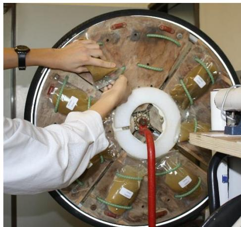
Installation des échantillons sur 2 systèmes rotatifs différents (16 sachets sur chacun)
