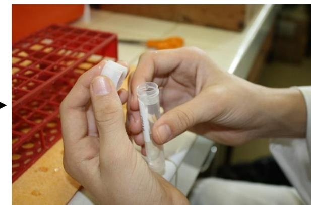
Filtration du surnageant et conditionnement en tubes de 10ml
