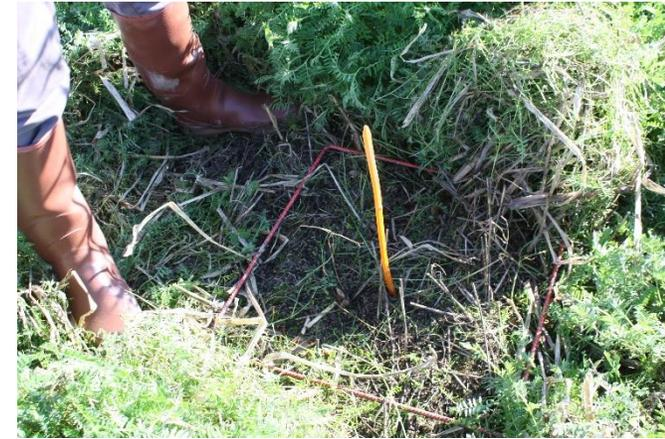
Prélèvement dans un cadre carré de 50cm de côté
