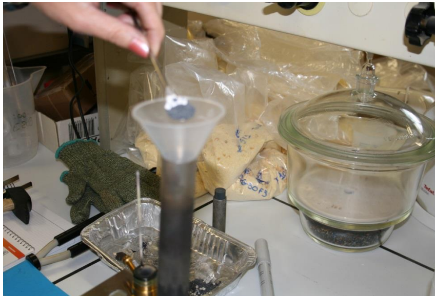
Verser avec la spatule pour garder un mélange homogène Tasser un peu le mélange
