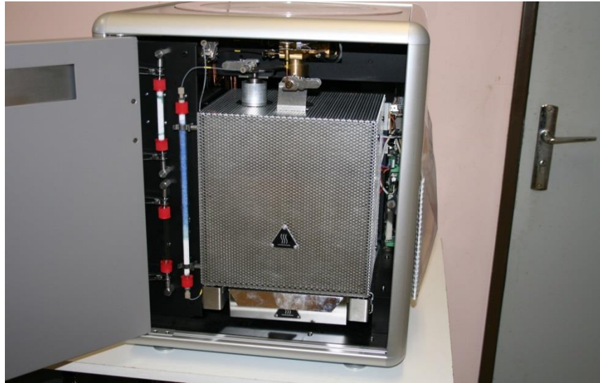
Ouverture de la porte coté droit et retrait du cache supérieur
