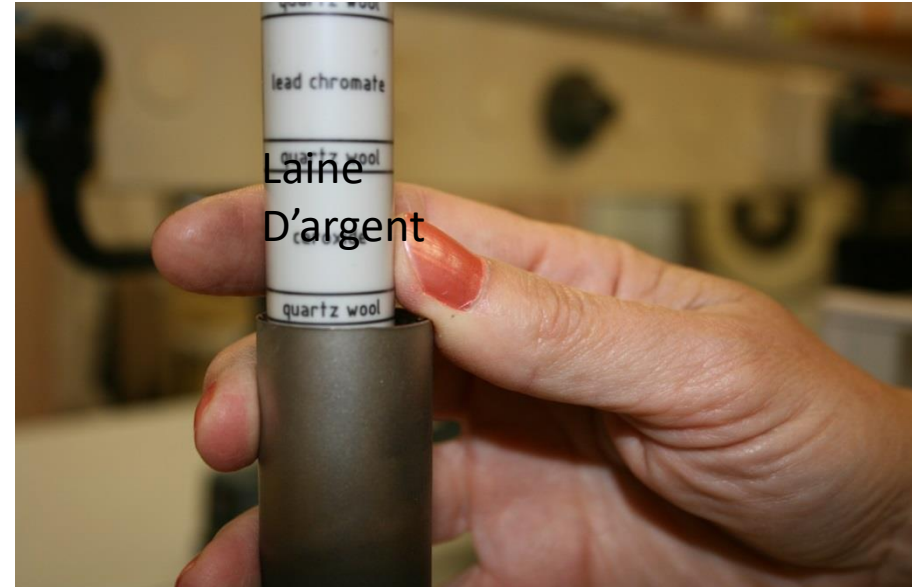
Control niveau de la laine d'argent
