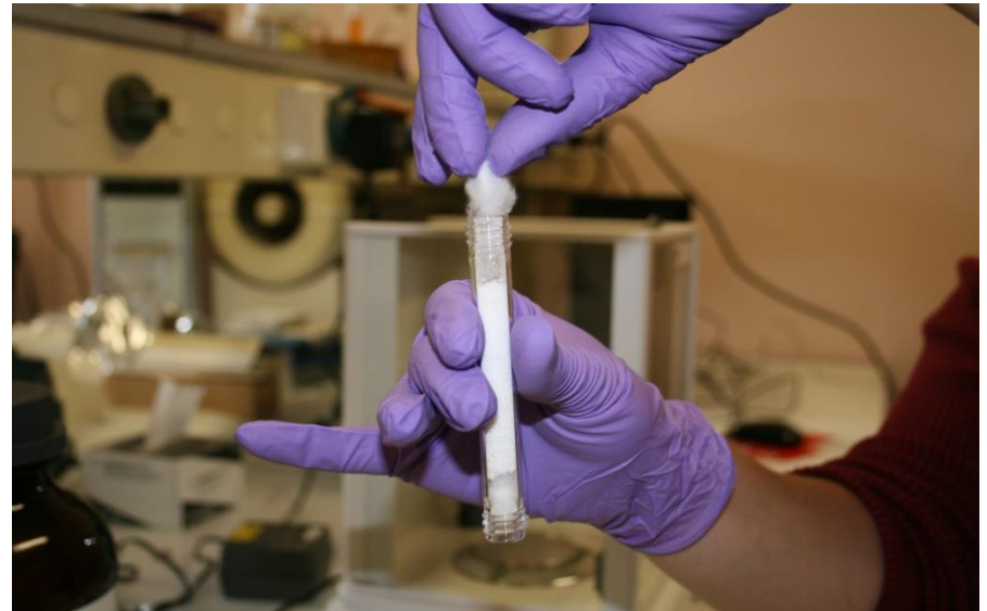
Ajout du sicapent et fermeture du tube (pas de vis propre et libre)
