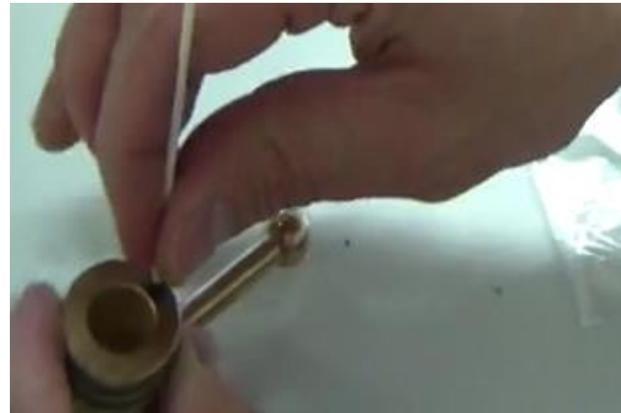
En tournant insertion de l'ensemble dans le raccord laiton
