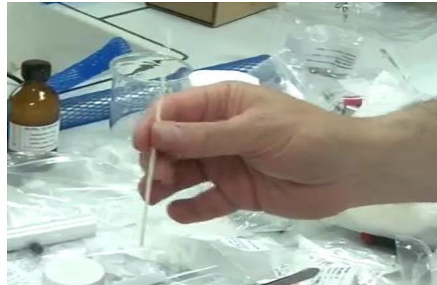
Lance pour guider l'oxygène (céramique)
