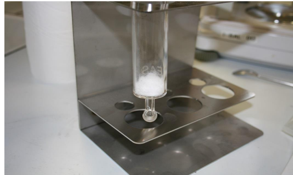
Laine de Quartz tassée au fond du tube
