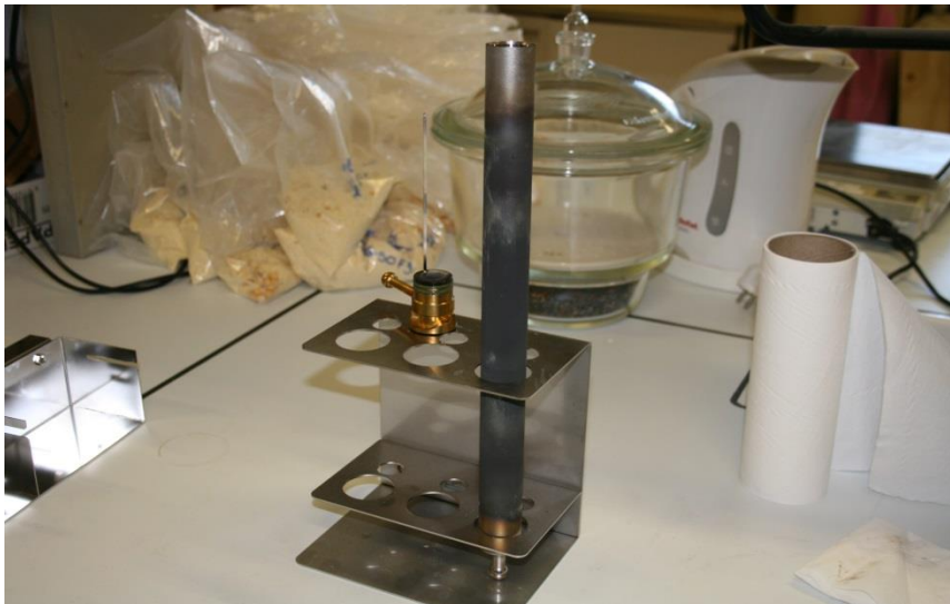
Control du joint pour installation du nouveau tube de combustion
