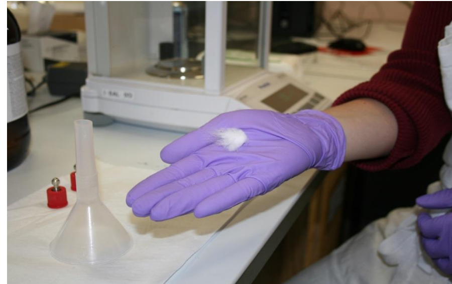
Préparation du bouchon coton (1cm minimum)
