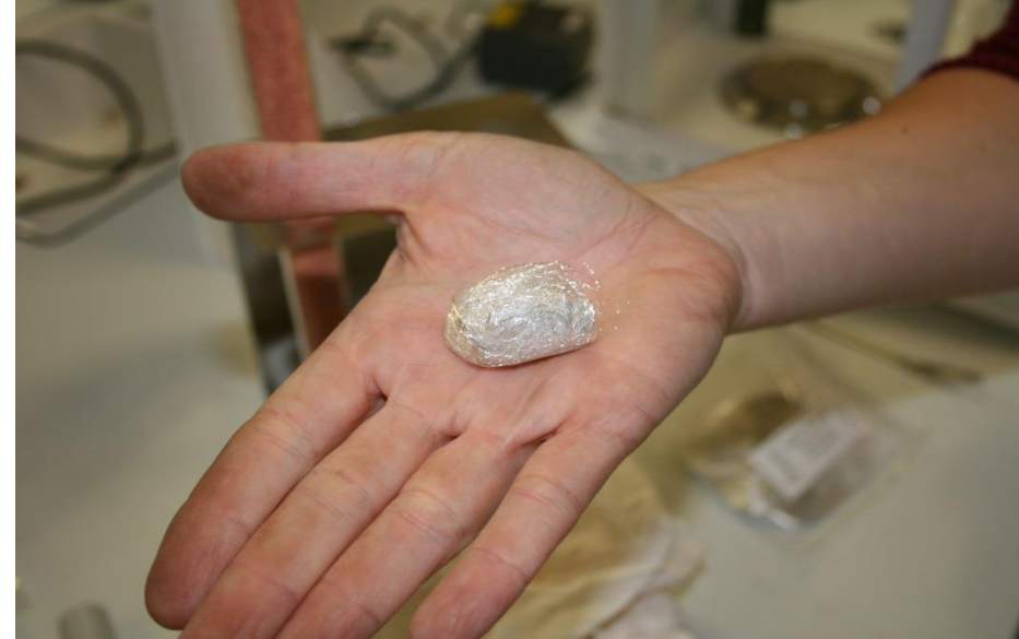
Bouchon de laine d'argent (récupération possible)
