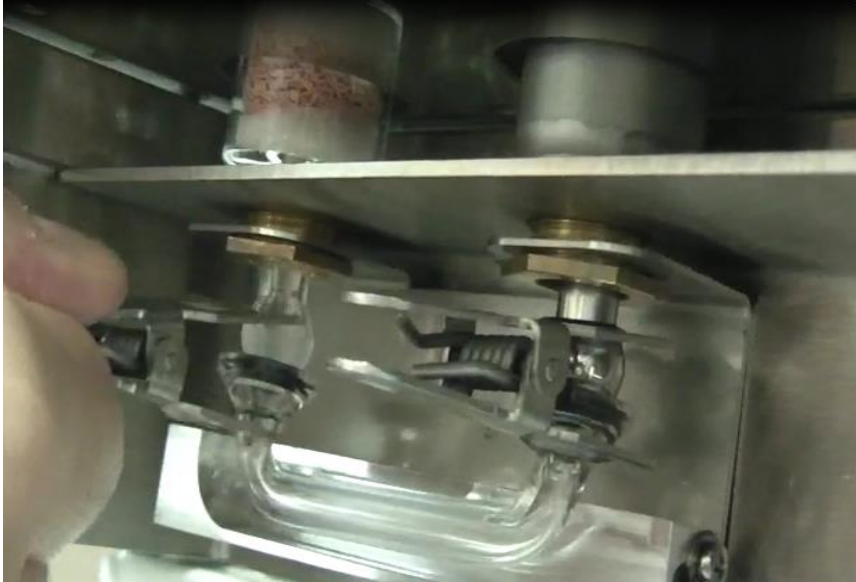
Replacer le pont quartz
