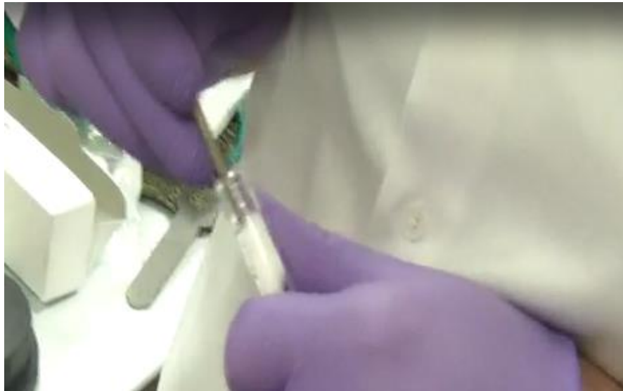
Placer le coton en laissant le pas de vis libre et bien l'essuyer (zone sans sicapent)
