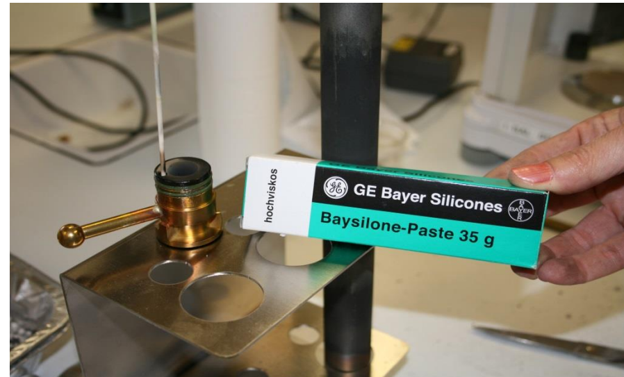
Control du joint pour installation du nouveau tube de combustion
