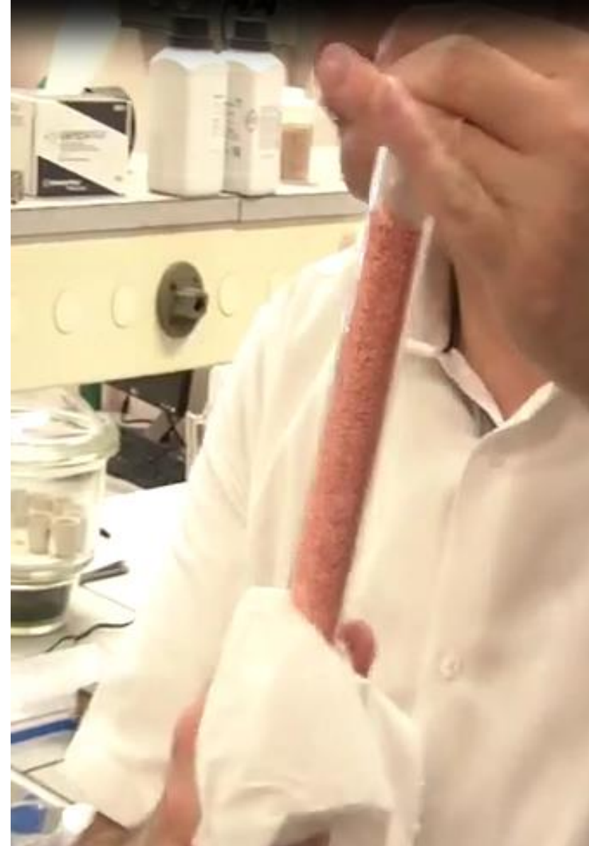
Nettoyage du tube à l'acétone
