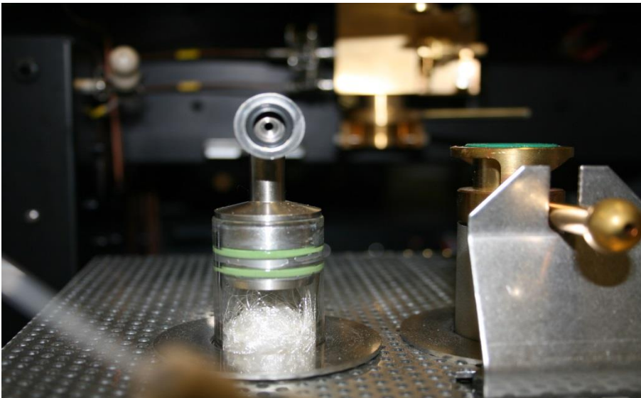
Remise en place du tube (pas de silicone joint noir)
