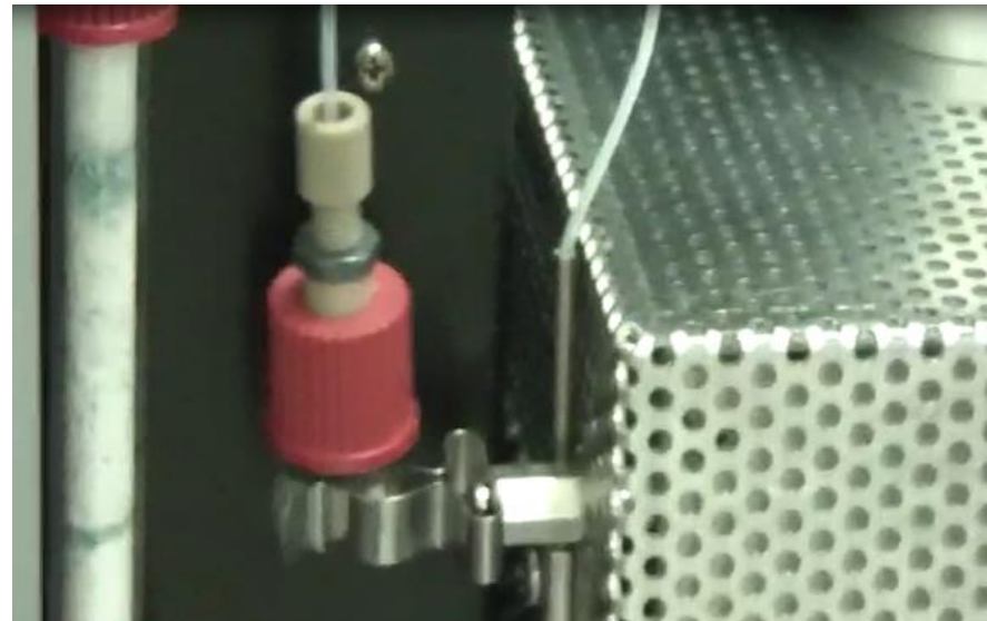
Fixer le tube dans le clips et procéder à l'identique pour la partie supérieure
