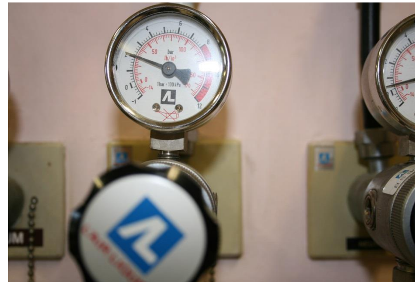
Pression d'hélium ajusté a 1,8bar(1250mbar)
