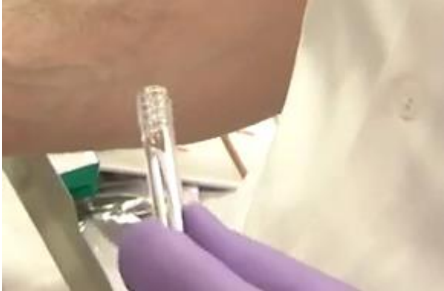
Nettoyage du tube, séchage, préparation du bouchon coton (pas de vis propre et libre)
