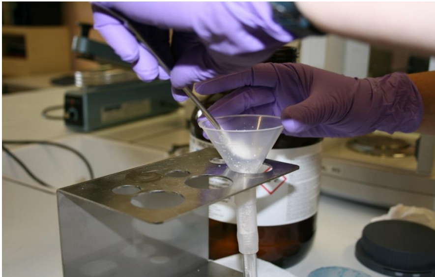
Ajout du sicapent et fermeture du tube (pas de vis propre et libre)
