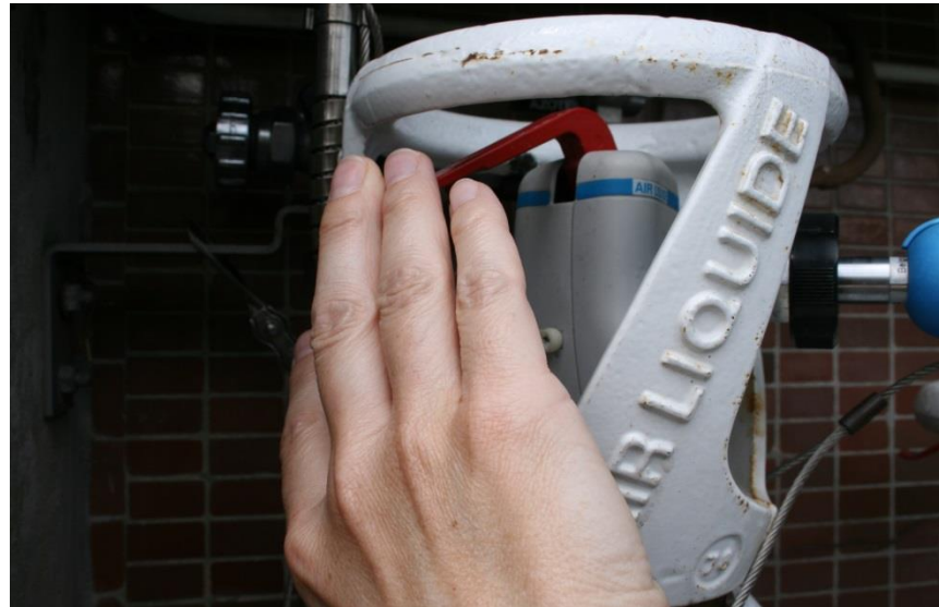
Fermeture du gaz au niveau de la bouteille puis au niveau du circuit
