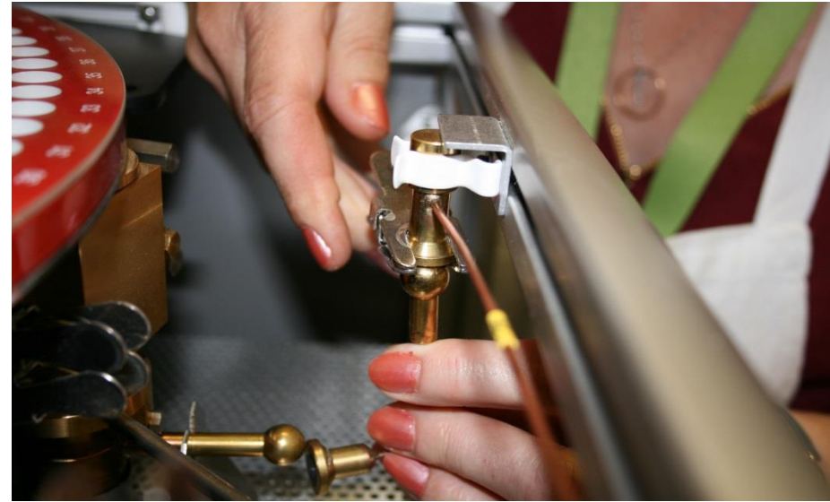
Blocage de la bague laiton du tube de combustion et fixation du tube d'oxygène
