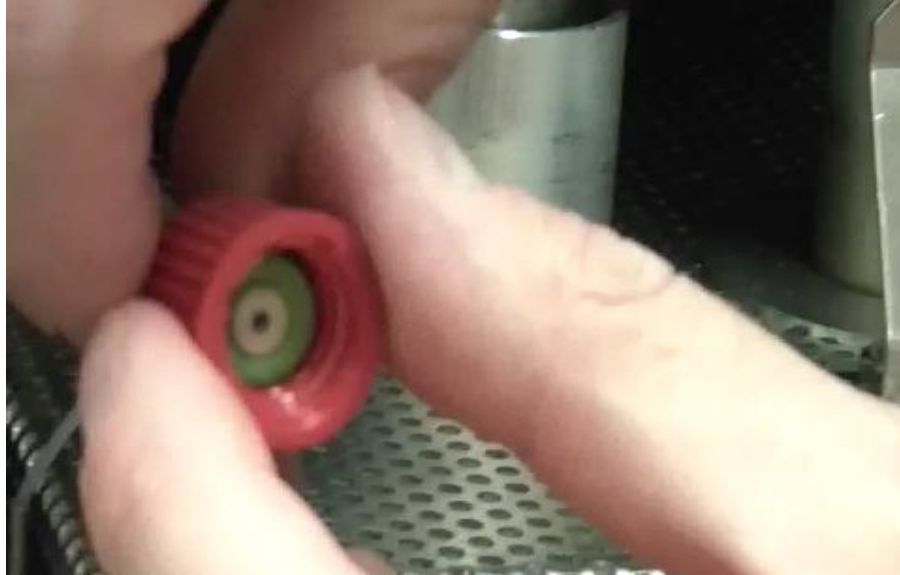
Control de la présence du joint vert et fixation du connecteur
