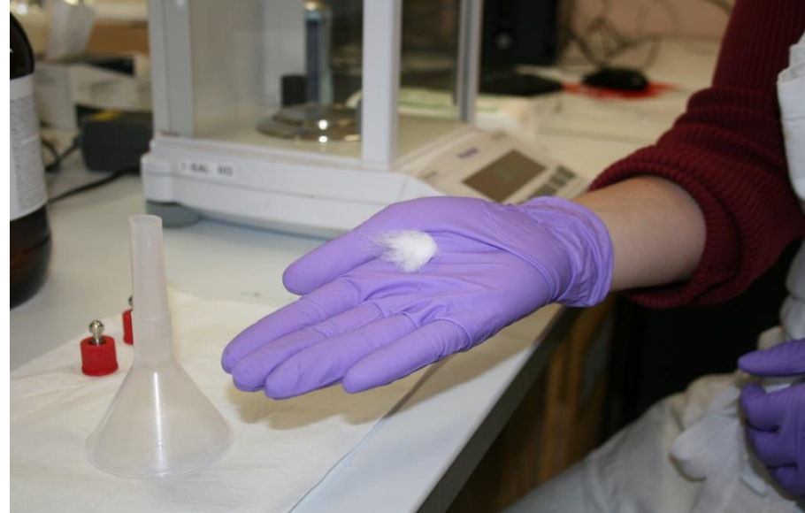
Nettoyage du tube, séchage, préparation du bouchon coton (pas de vis propre et libre)
