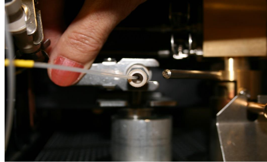
Connexion du tubing
