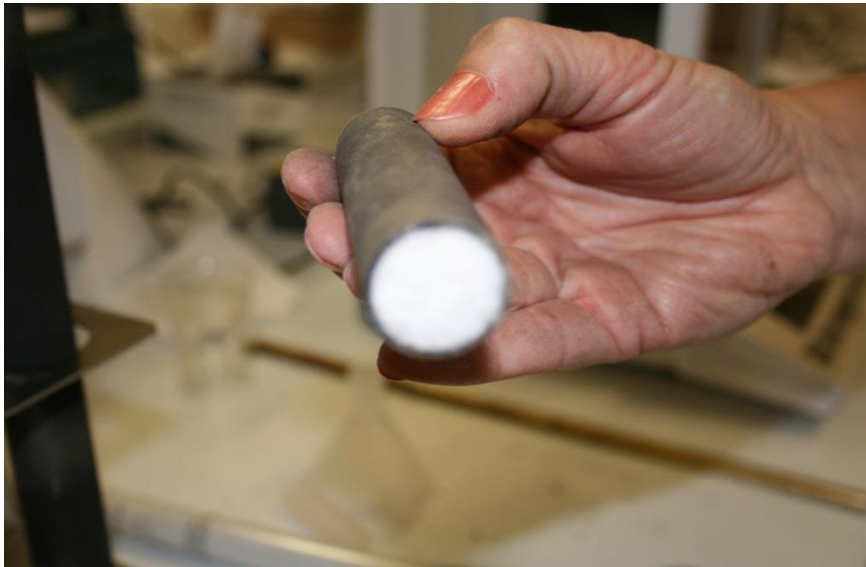
Préparation du cendrier et mis en place (12cm entre haut du cendrier et extrémité du tube)
