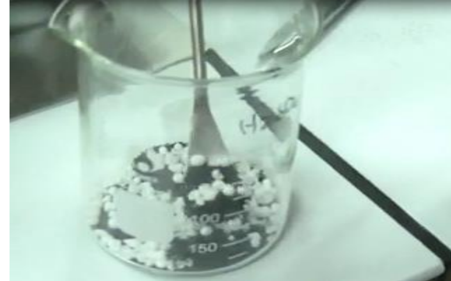
Mélange billes et oxyde de cuivre (20%/80%)
