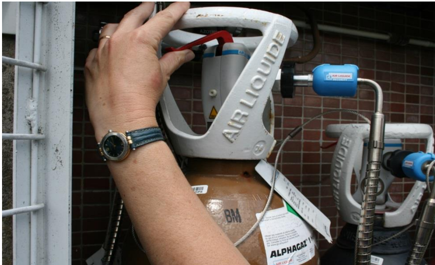
Ouverture de la bouteille mis en pression control manomètre
