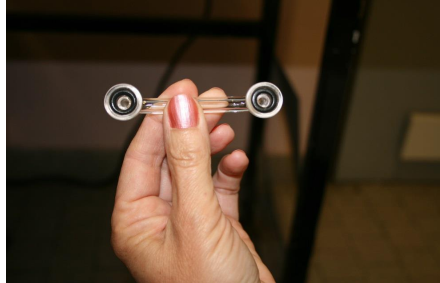
Control joint du pont quartz (si démonté)
