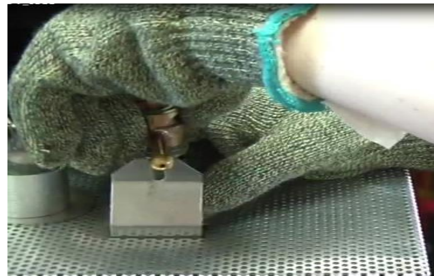
Retrait du raccord laiton au tube de combustion (cf ouverture appareil)
