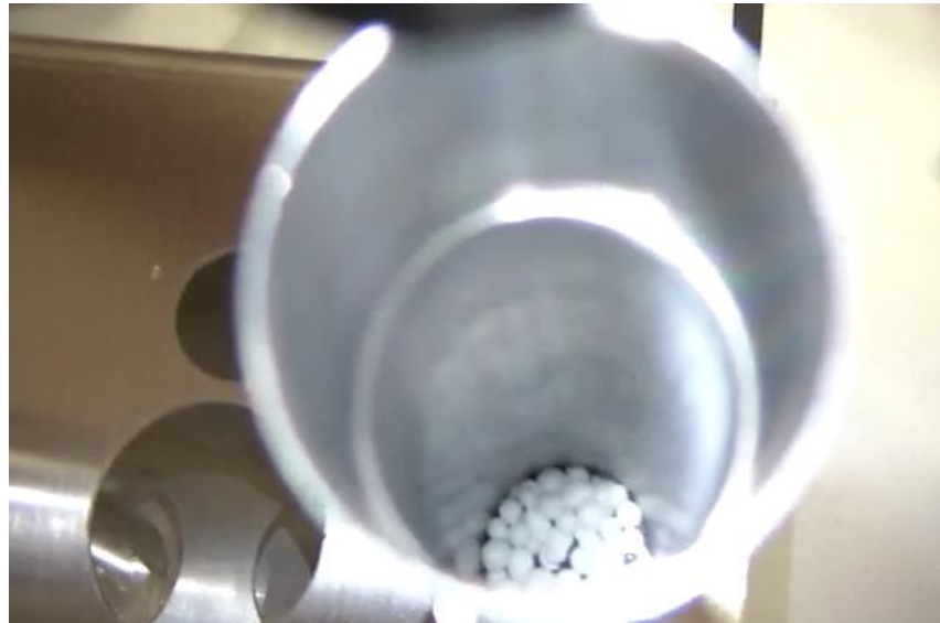
Ajout d'une couche de billes d'alumine
