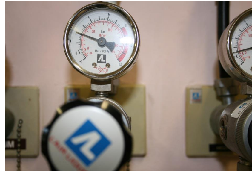
Pression d'hélium ajusté a 1,8bar(1250mbar)
