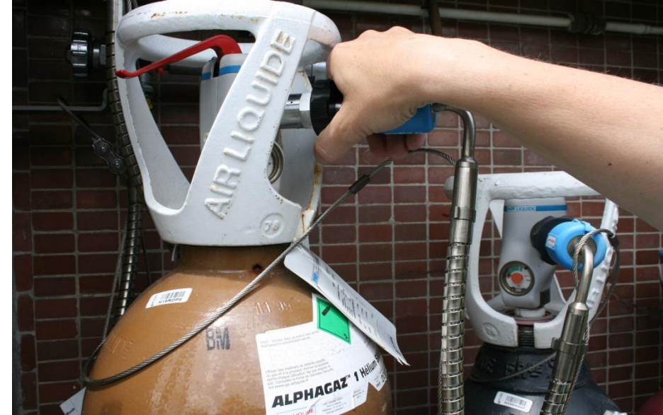
Ouverture et fermeture de la vanne de purge et ensuite retrait du flexible d'alimentation
