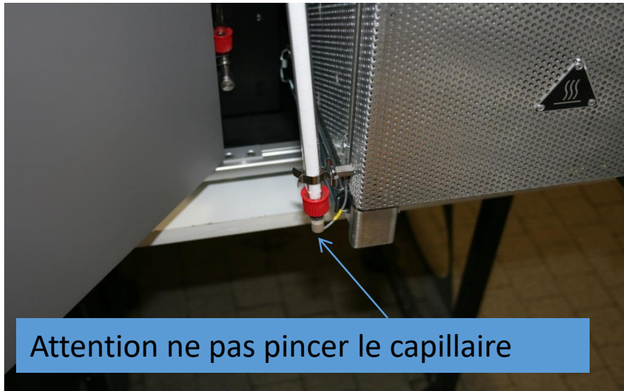
Fixer le tube dans le clips et procéder à l'identique pour la partie supérieure
