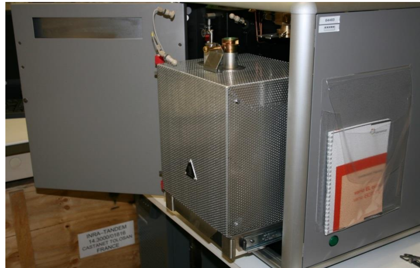
Désolidarisation du tube de combustion et déport du bloc
