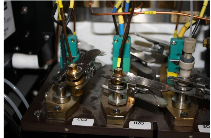
Retrait de la bille sur la ligne SO 2 et installation du tubing attention aux joints noir
