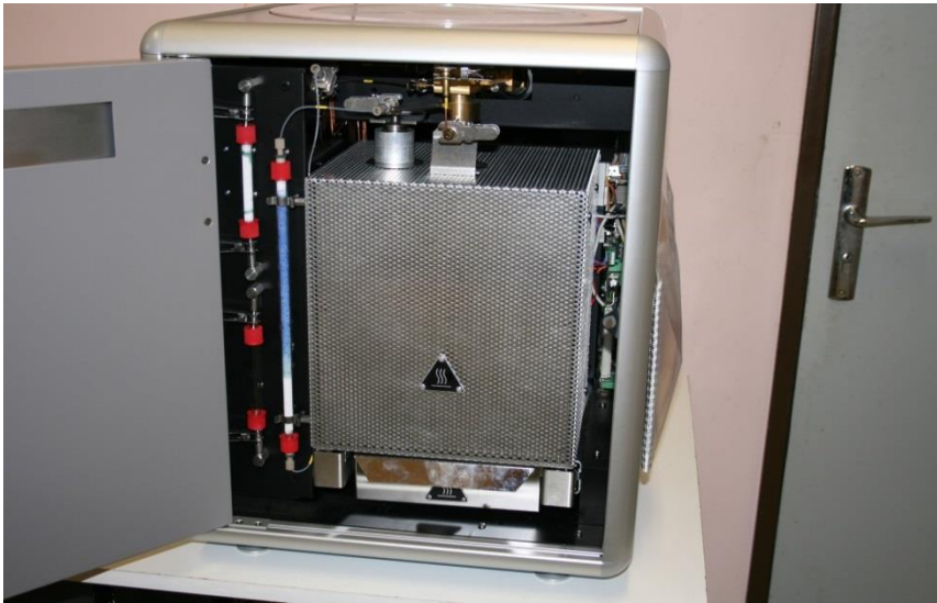
Ouverture de la porte coté droit et retrait du cache supérieur+ obturateur laiton
