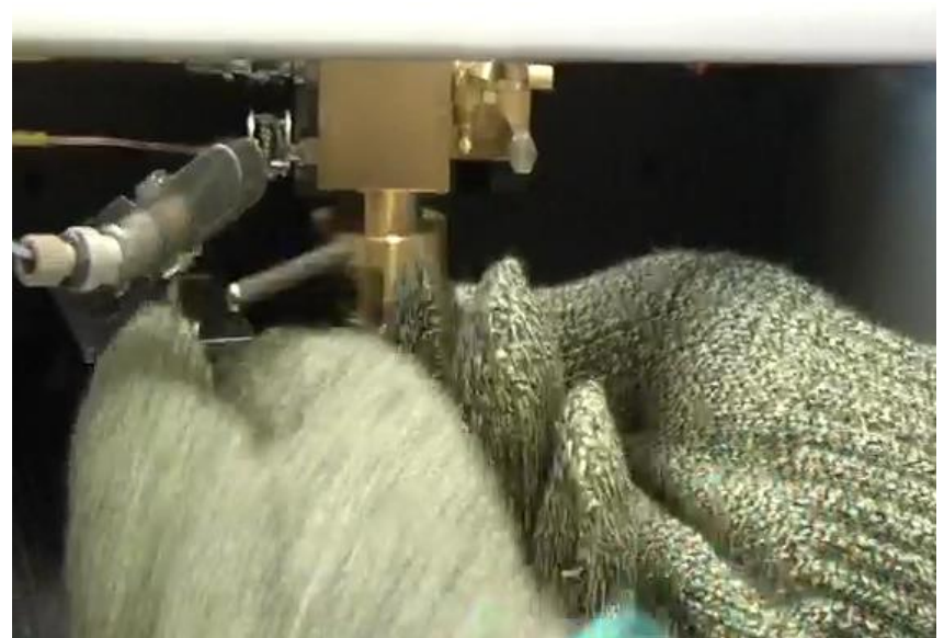
Retrait du raccord laiton au tube de combustion et déblocage de la bague de raccordement
