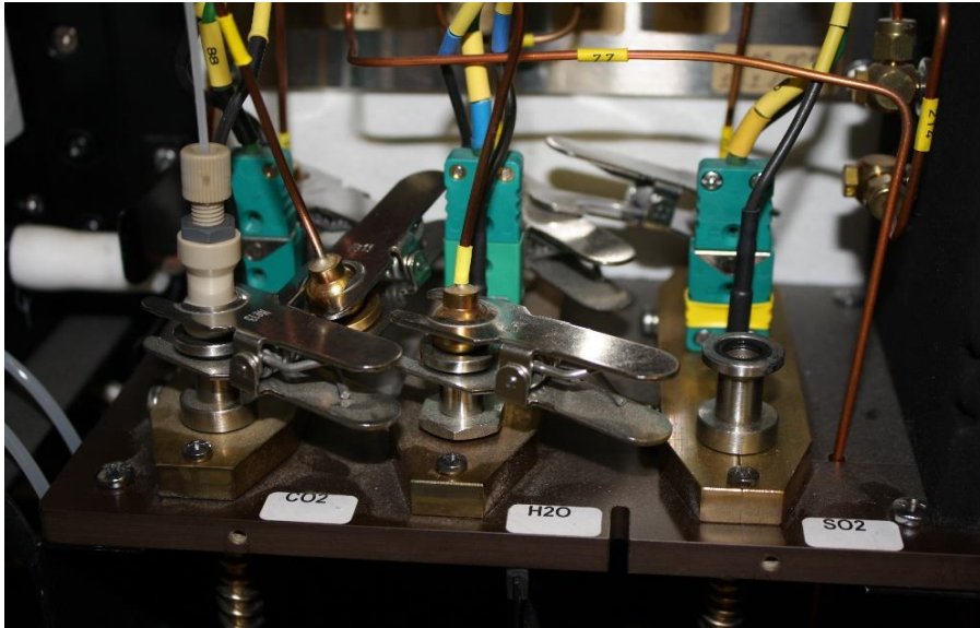
Retrait de la bille sur la ligne SO 2 et installation du tubing attention aux joints noir
