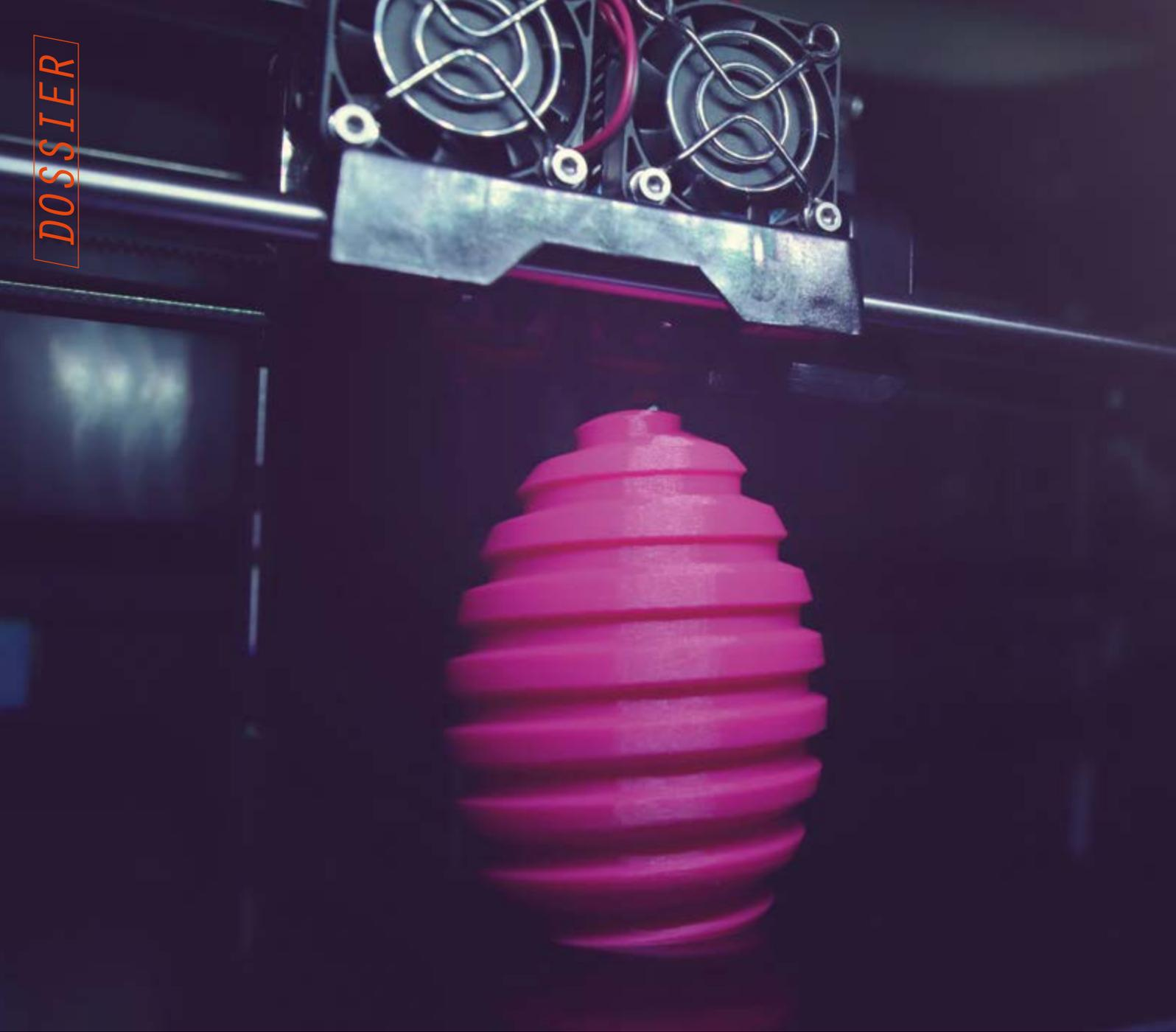
Depuis l'origine de la technologie, les plastiques sont les matériaux les plus utilisés en fabrication additive. Ils présentent des caractéristiques très différentes en termes de propriétés physiques, de couleurs, de transparence, de biocompatibilité, de résistance, de rigidité, de dureté, d'élasticité, etc. Ils se présentent sous forme de poudre, de granulé ou de filament. Un vaste choix pour de nombreuses applications.
