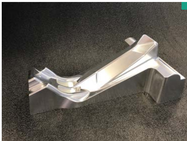
OUTILLAGE DE THERMOFORMAGE AVEC CANAUX CONFORMABLES, POUR L'AÉRONAUTIQUE, RÉALISÉ EN STRATOCONCEPTION ALUMINIUM (1 MÈTRE).
