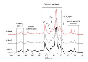
Fig. 1 Solid  $^{13}$ C NMR spectra of ViSh-V (—), ViSh-C (—) and ViSh-G (—)
