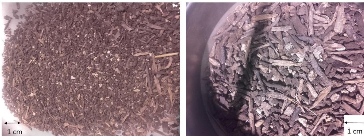
Photographies 22 : Agglomérats de différentes tailles dans l'échantillon E24.
