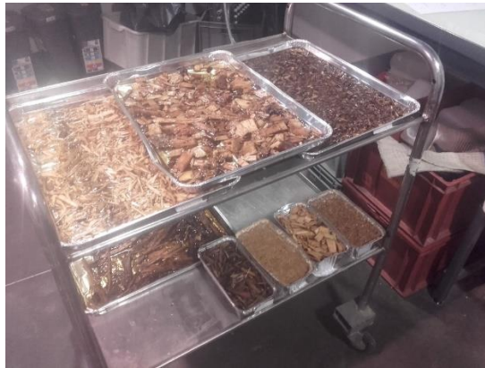
Photographie 4 : Trempage des échantillons pendant 24 h.
