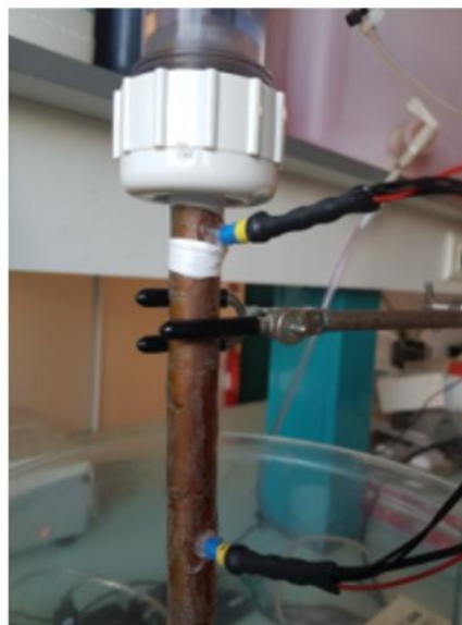
Figure 53 : photo du manchon étanche et de la sonde
