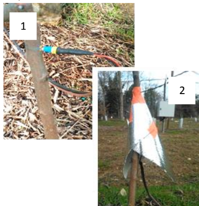
Figure 15 : photo de la sonde TTD insérée dans un pommier (1) et du déflecteur qui la recouvre (2)
