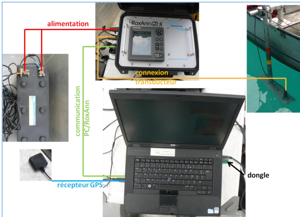
Figure 1. Matériel composant le système RoxAnn® (photos : Poulain, Argillier, et Guillard 2010).
