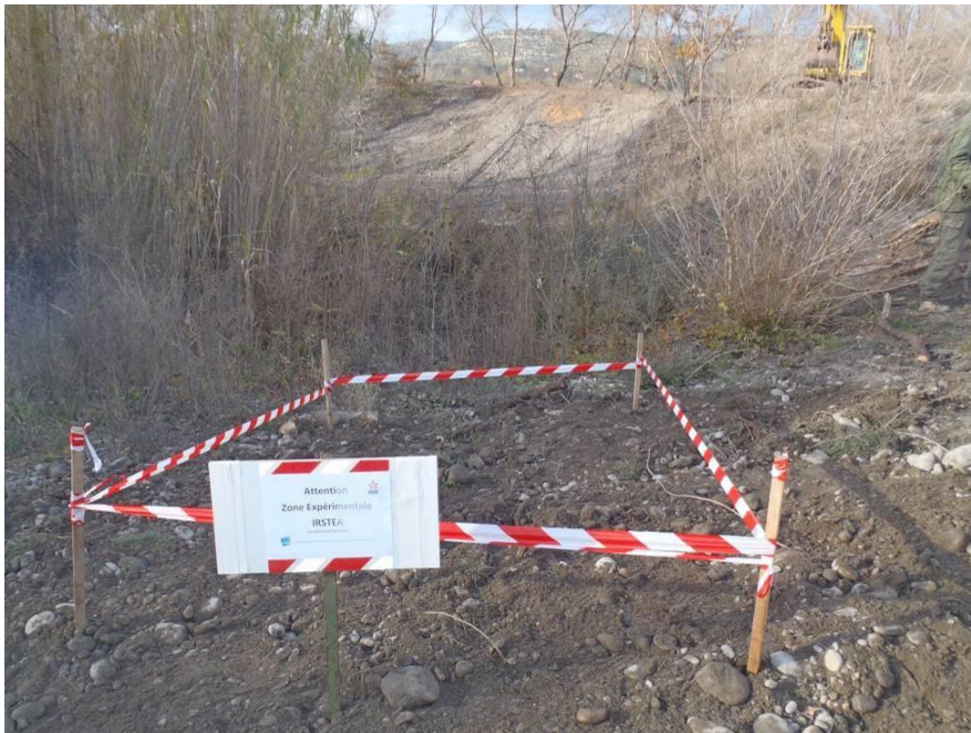
Figure 7 : enfouissement des échantillons sous 50 cm de matériaux.
