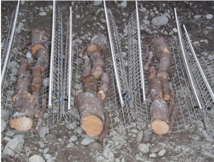
Figure 6 : positionnement des échantillons dans les paniers en grillage inoxydable.
