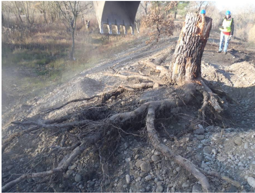
Figure 4: Système racinaire de pin d'Alep extrait de la crête de la digue. Ce sont des segments de telles racines qui ont été utilisées pour l'expérimentation.
