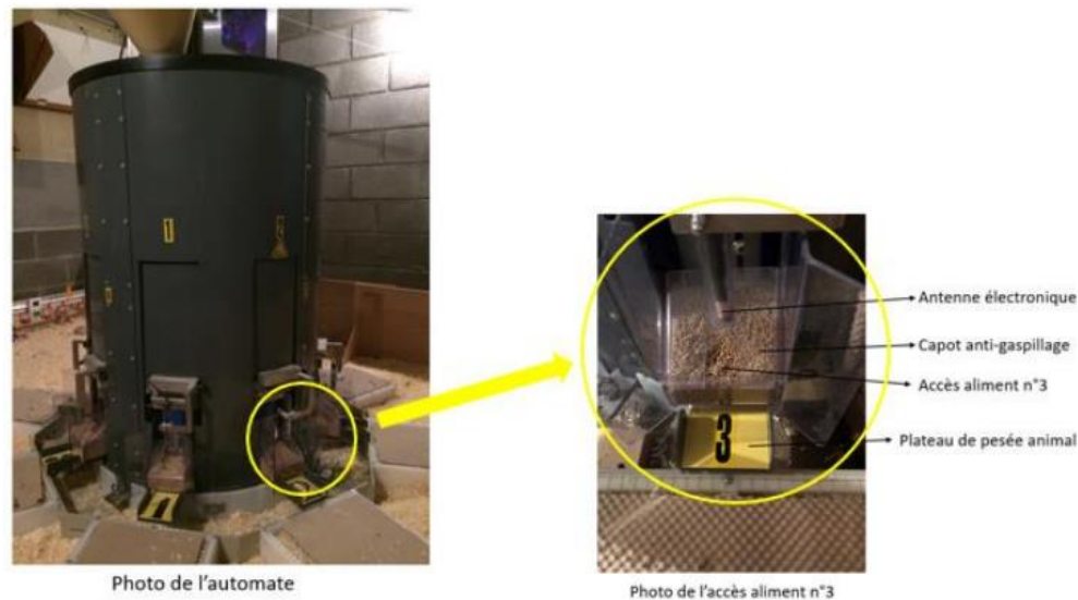
Figure 2 : Automate de consommation BIRD-e et détail d'un accès à l'aliment
