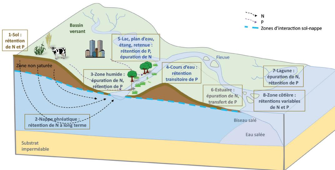
Figure 2. Schéma conceptuel des zones de transfert, rétention et épuration de l'azote (N) et du phosphore (P) le long du continuum terre-mer. Source : ESCo Eutrophisation.
