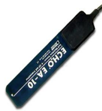
Figure 7 : Boitier HOBO et thermocouple Type T Figure 8 : Boitier DECAGON Em50 et sonde ECHO 10
