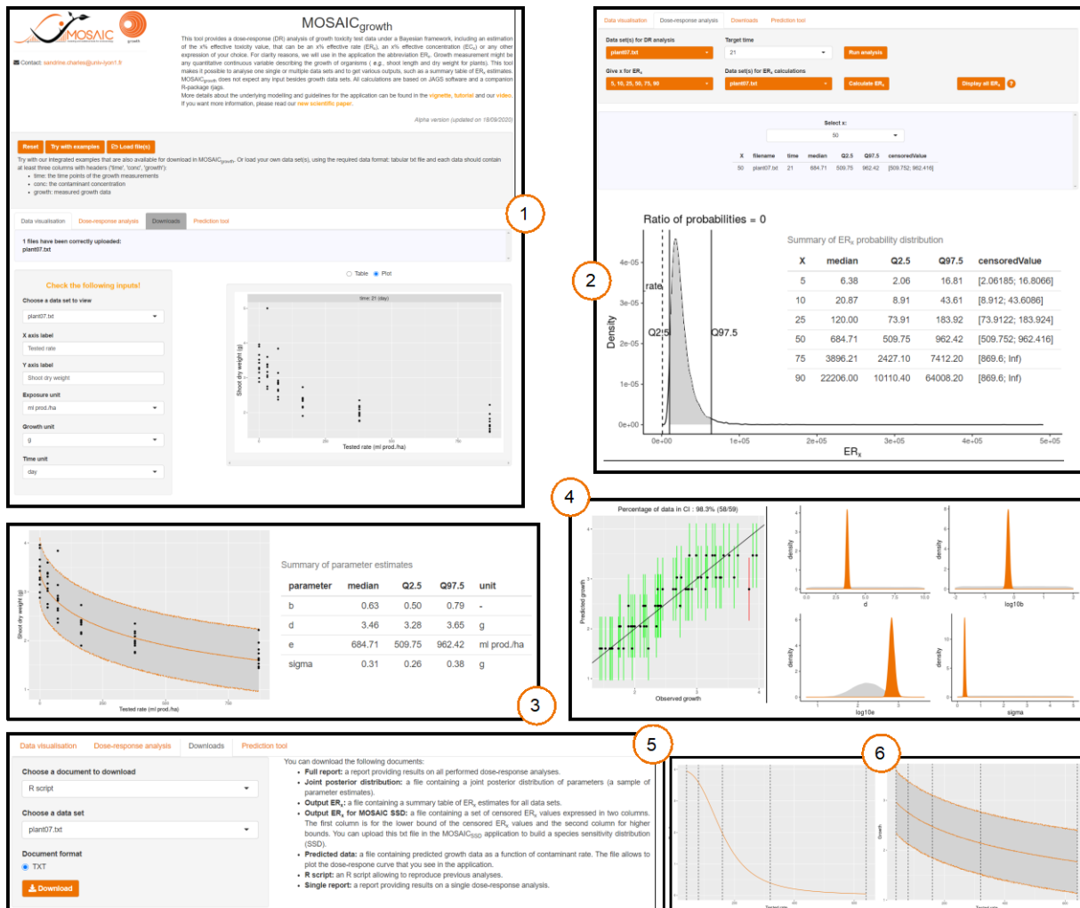
Figure 1. Morceaux choisis de l'interface web MOSAIC growth lors de l'analyse dose-réponse avec le jeu de données exemple 'plant07' : (1) Saisie des données expérimentales et leur visualisation ; (2) Estimation des ER_x pour x = 5, 10, 25, 50, 75 et 90% obtenus à partir des résultats de l'ajustement du modèle DR et représentation graphique de la distribution de probabilité de l' ER_{90} ; (3) Modèle ajusté superposé aux données observées : courbe médiane (ligne orange en trait plein) et son incertitude (zone grisée délimitée par les lignes pointillées orange) et résumé des paramètres estimés ; (4) Exemple de deux critères d'ajustement du modèle fournis par l'interface (à gauche : 'Posterior Predictive Check' (PPC) ; à droite : priors et posteriors) ; (5) Téléchargement des résultats et (6) Exemples d'utilisation de l'outil de prédiction pour une série de concentrations (40, 80, 160, 320 et 640) ; à gauche : paramètres non distribués ; à droite : paramètres distribués obtenus lors d'une analyse DR antérieure effectuée avec MOSAIC growth .
