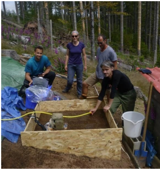
Fig. 1 - Infiltration de sol réalisée sur le bassin versant du Strengbach, juillet 2020
