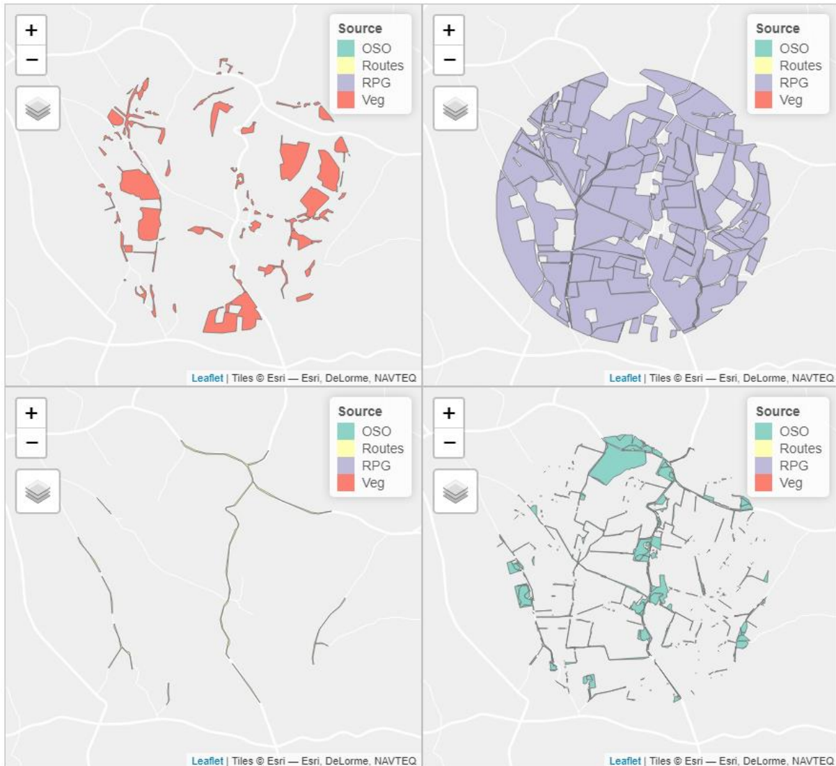
Figure 12. Représentation visuelle du remplissage séquentiel d'un buffer par chacune des couches vectorielles sources. La première couche d'information incorporée (Veg) renseigne 12 % de l'occupation du sol du buffer (haut-gauche). La couche suivante (RPG) complète le remplissage (haut-droite) en renseignant 78 % d'occupation du sol supplémentaire. La troisième couche permet de renseigner les routes dans les zones restées non renseignées. Enfin le remplissage final est réalisé avec la couche OSO et permet un remplissage intégral du buffer considéré.
