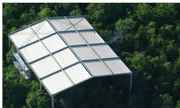
Vue de l'O 3 HP : Système d'exclusion de pluie déployé sur la forêt de chênes pubescents permettant de simuler l'aggravation de la sécheresse prévue par les scénarios de changement climatique (à gauche système ouvert – système fermé permettant l'exclusion).
