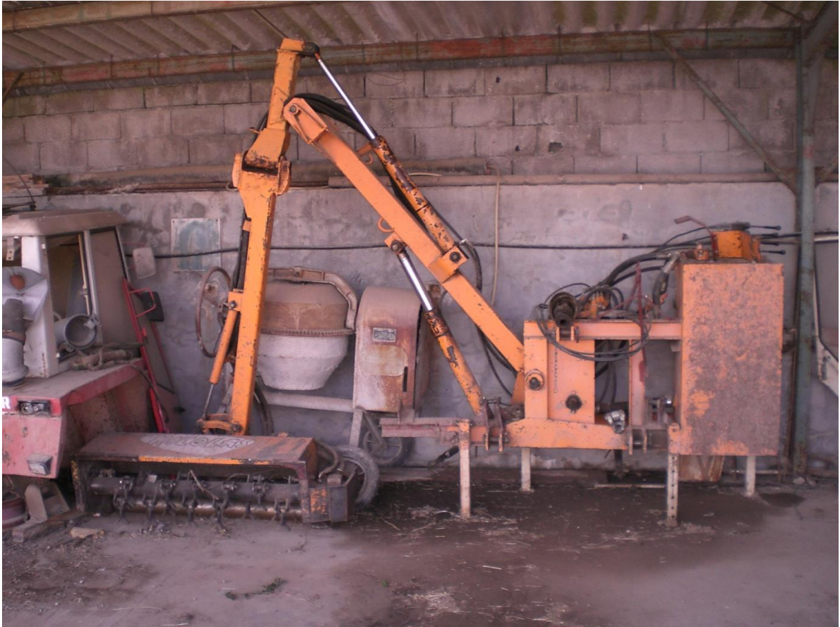
Cliché 27 : Épareuse de l'INRA de Mirecourt (bras + outil)
