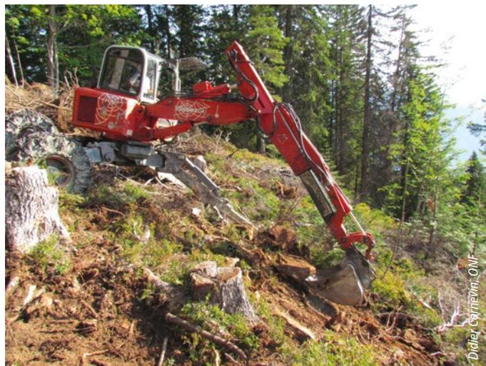
Figure 5. Pelle-araignée équipée d'un godet décapant le sol, Esserts-Blay (73).
