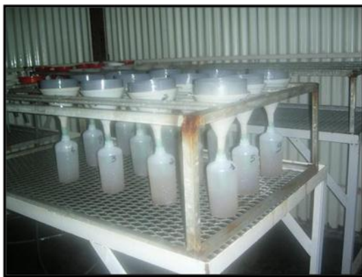
Figure 8: dispositif d'extraction des nématodes par brumisation (source: Deloné, 2006)
