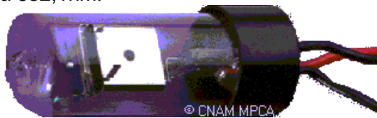
Figure 2 : lampe UV au deutérium
