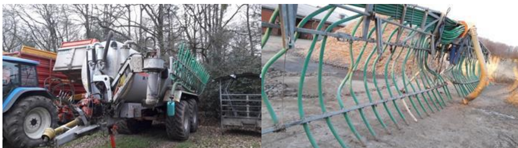
Figure 4 - tonne à lisier et détail de la rampe à pendillard
