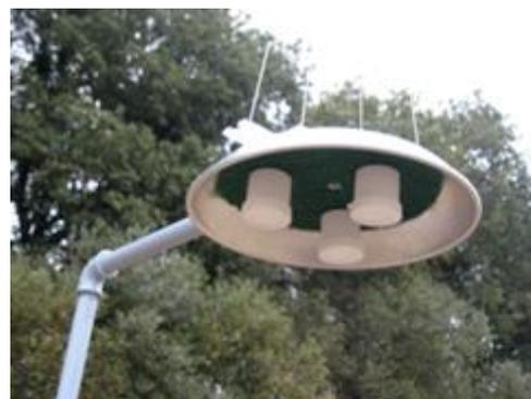
Les alentours du site d'essai sont également équipés de 4 mats de 3 m positionnés en fonction du régime de vent dominant ( $\text{NH}_3$  ambiance), ils permettent de mesurer le « bruit de fond » des émissions (influence des élevages ou d'usines avoisinantes par exemple). Ils sont positionnés à une distance d'environ 300 m du dispositif.
