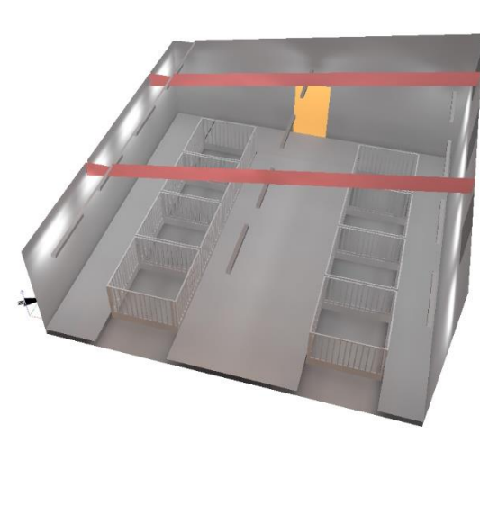
Répartition en fausses couleurs et rendu 3D du niveau d'éclairage dans l'hébergement 1
