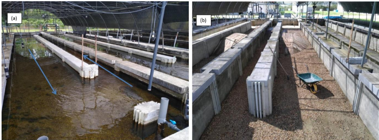
Figure 3 : Rivières artificielles de la station expérimentale INRAE de Saint-Seurin-sur l'Isle, en (a) : rivière en eau avec le sens du courant représenté par les flèches bleues, en (b) : rivière en assec pendant la pose des structures et du substrat (INRAE, 2019).
