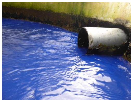
Figure 103 : Bêche d'alimentation de la file 1 avec le traceur amino G
