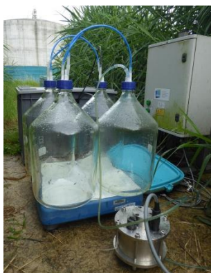
Figure 102 : Dispositif expérimental pour le traçage de l'eau du sol au point P12
