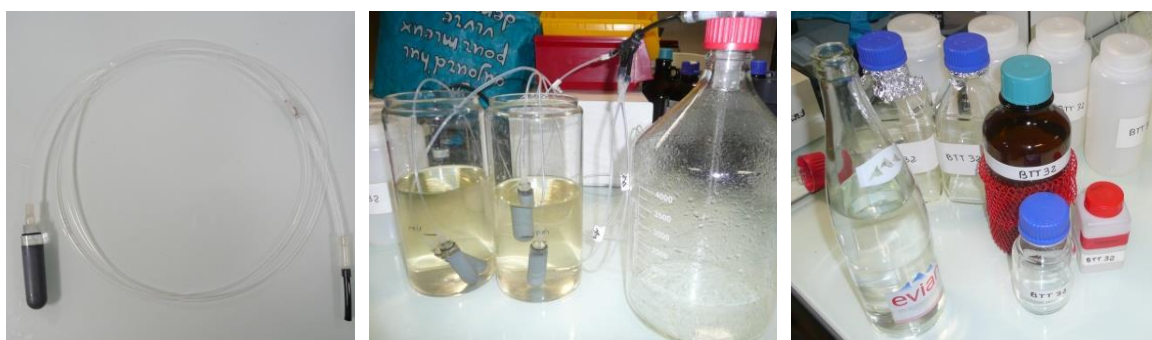
Figure 98 : Photographies illustrant le test d'altération des échantillons par les bougies poreuses
