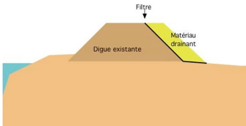
Figure 4.10 : Recharge drainante et filtre (schéma : R. Tourment)
