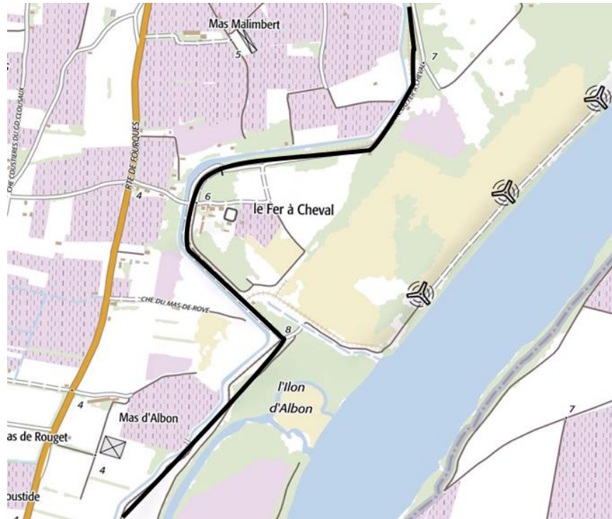
Figure 10.4 : "Fer à cheval" sur une réparation de brèche sur une digue du Rhône, qui a d'ailleurs donné son nom au lieu-dit (fond de plan IGN Géoportail)
