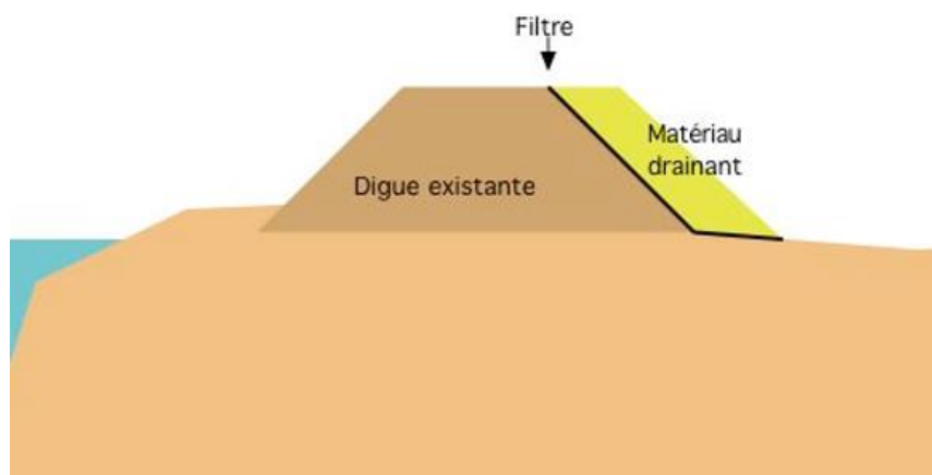
Figure 4.10 : Recharge drainante et filtre (schéma : R. Tourment)
