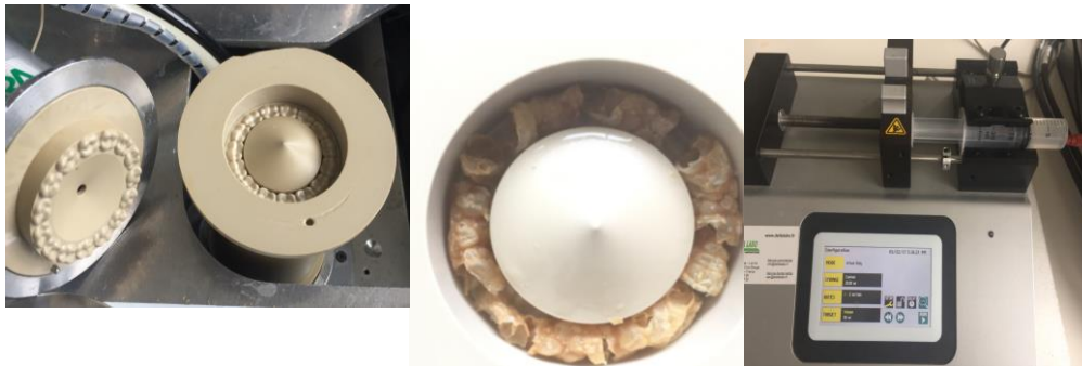
Fig.8 : 8a-8b : deux images montrant la bouche artificielle vide et remplie. 8c : pousse-seringue avec la seringue contenant la salive artificielle.
