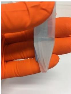
*Attention : Veiller à ce que les filtres soient bien placés au fond du tube c'est-à-dire vers la partie conique sans les coincer au fond pour ne pas gêner l'extraction à l'acétone qui se fera ultérieurement.*
