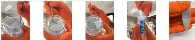
*Attention : Veiller à ce que les filtres soient **totalemtent immergés** dans le liquide. Insérer **maximum 2 filtres** par tube. Si besoin utiliser un tube supplémentaire.*
