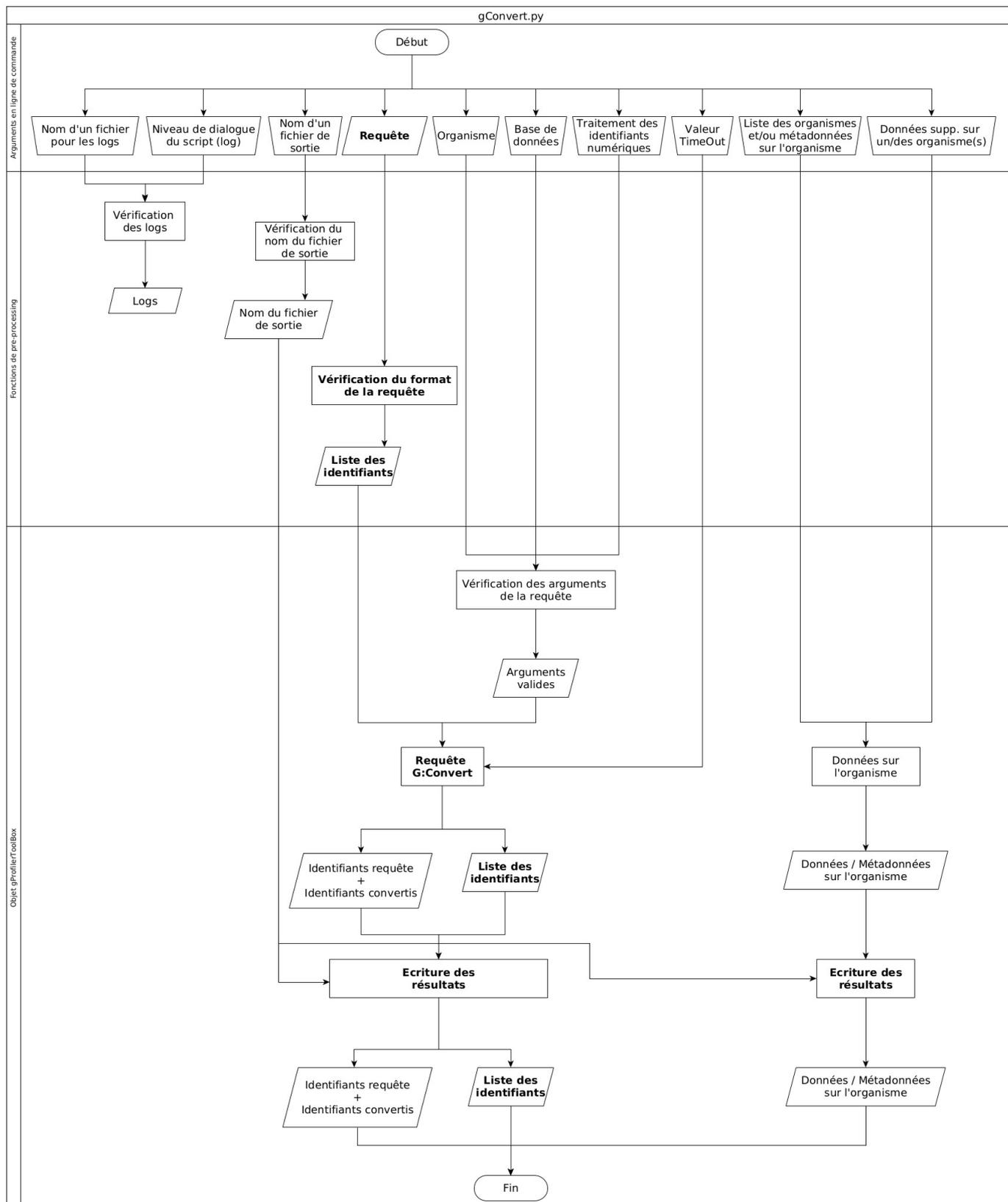
**Figure 6 | Algorithme du script Python g:Convert.** Les étapes clés sont en gras. Les données d'entrée et de sortie sont représentées par des parallélogrammes, les outils et les processus par des rectangles.
