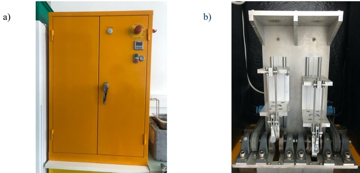
*Figure 10 a et b : Broyeur à bille, conçu par Frédéric Mercier*
