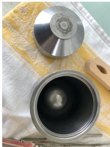
*Figure 11 : Bille et godet permettant le broyage*
