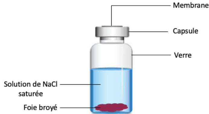
*Figure 12 : Contenant en verre utilisé pour nos échantillons*
