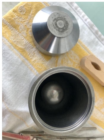
Figure 11 : Bille et godet permettant le broyage
