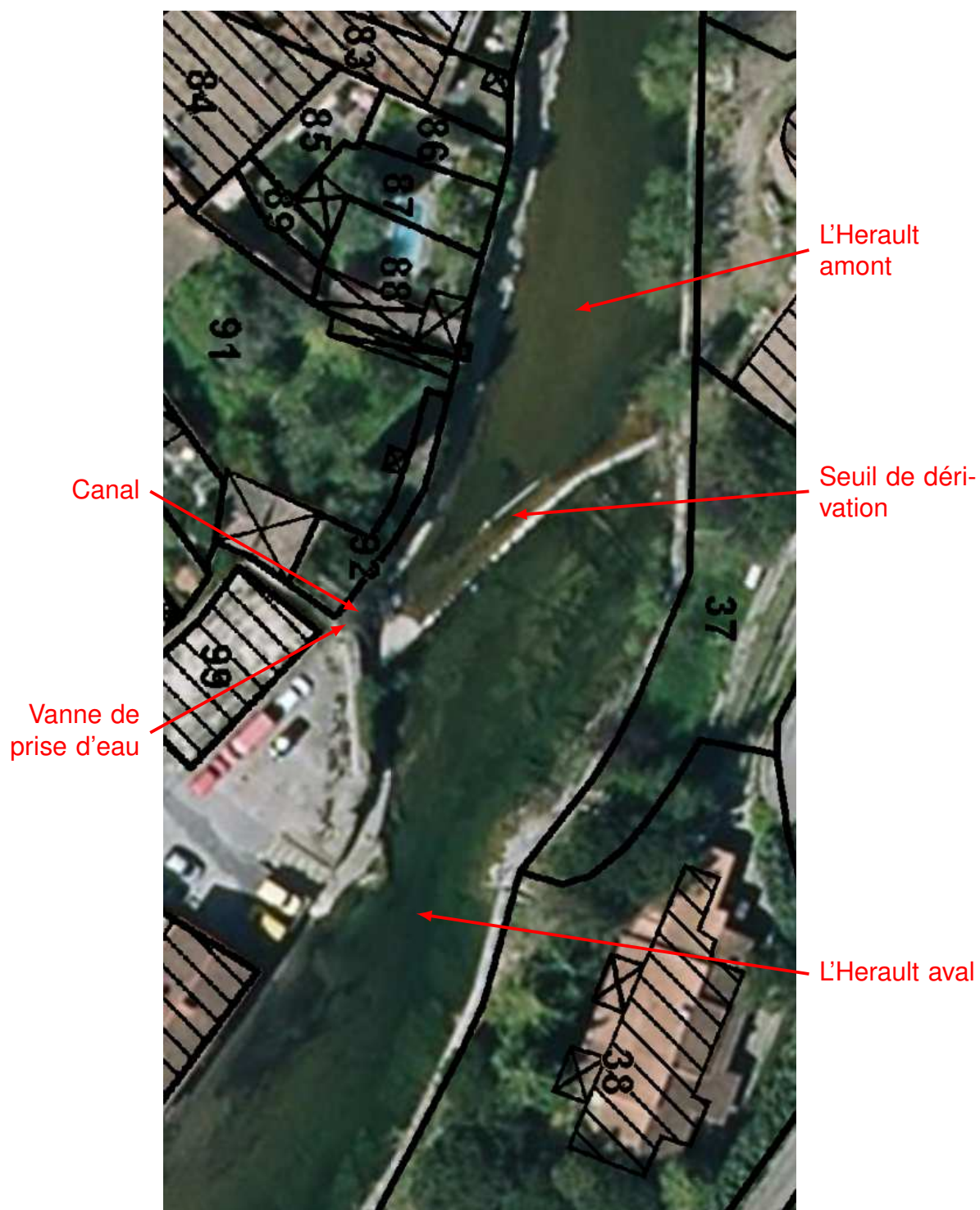
FIGURE 11.56 – Plan de la prise d'eau Canal de l'Agal ©IGN
