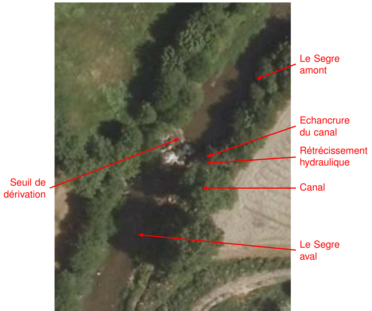
FIGURE 11.126 – Plan de la prise d'eau Canal de la Prades ©IGN
