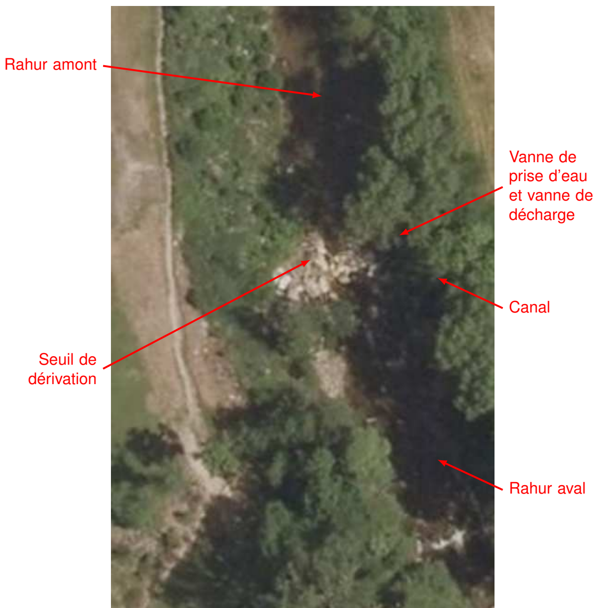
FIGURE 11.120 – Plan de la prise d'eau Canal du Mas Blanc ©IGN
