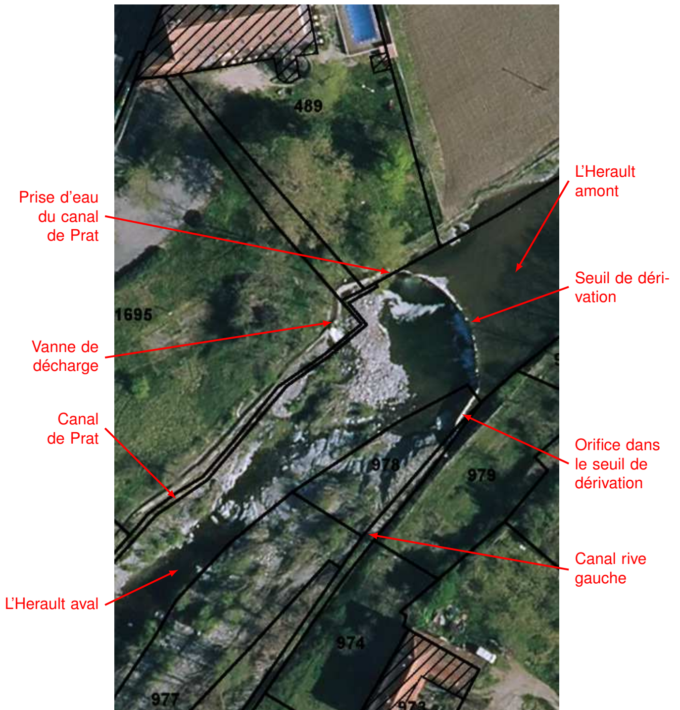
FIGURE 3.1 – Exemple de plan de prise d'eau : le Canal de Prat (Gard)
