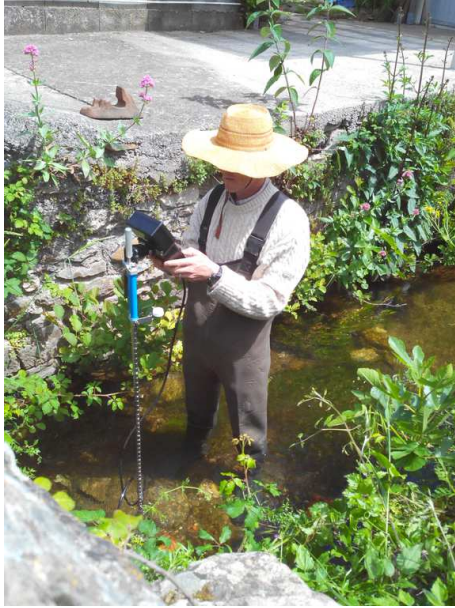
FIGURE 3.2 – Photo d'un opérateur utilisant l'ADV pour mesurer le débit d'un canal
