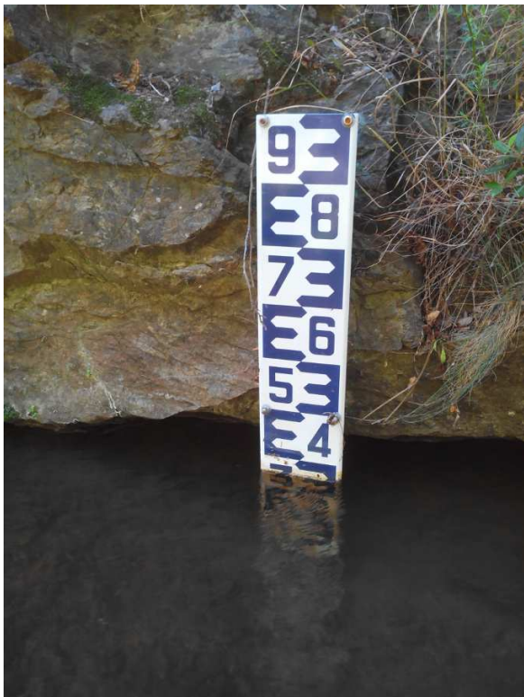
FIGURE 11.96 – Photo de l'échelle limnimétrique du canal de la plaine
