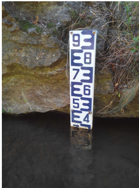
FIGURE 2.1 – Échelle limnimétrique (Canal de la plaine)
