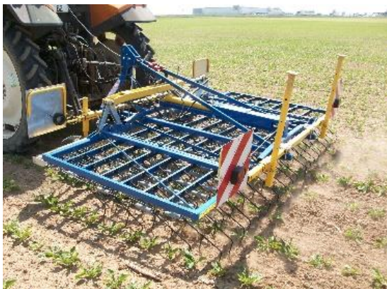
(C) : Herse étrille avec réglage des dents par ressorts
