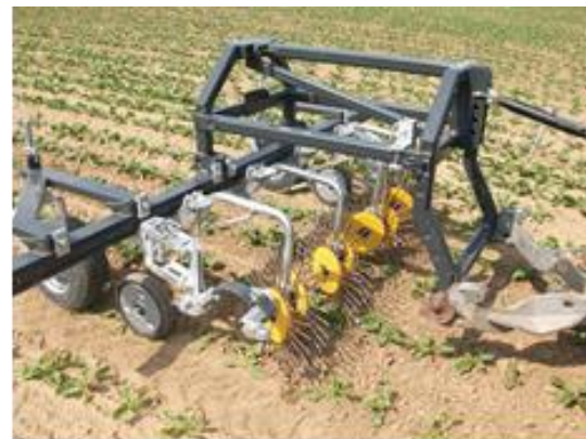
(D) : Roto étrille travaillant sur le rang des betteraves
