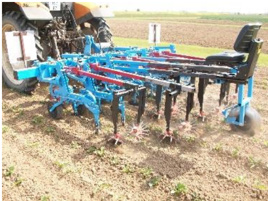
(A) : Bineuse classique d'inter-rang équipée de moulinets travaillant sur le rang
