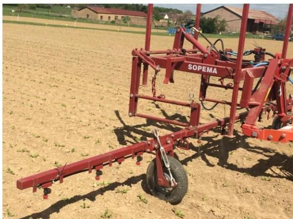
**Figure 6 :** Rampe de localisation du traitement sur le rang.
