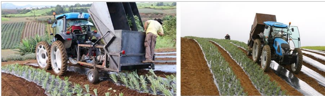
Figure 15 : Validation du prototype d'assistance à la plantation chez les producteurs
