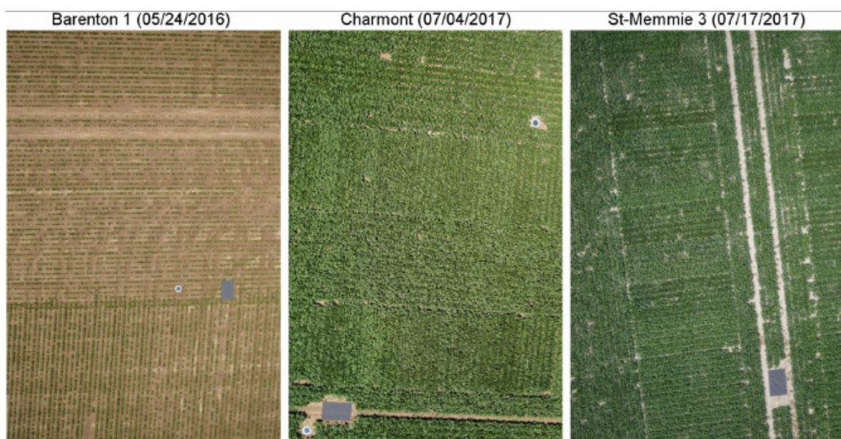
Fig. 5 : Images de cultures de betteraves acquises à l'aide d'un hexacoptère équipé de caméras RGB, sur trois sites présentant des différences de stades de développement des plantes, de fertilisation azotée et de propriétés des sols. Le rectangle gris est utilisé pour la calibration radiométrique et le cercle pour le géoréférencement (d'après Jay et al. 2019).
