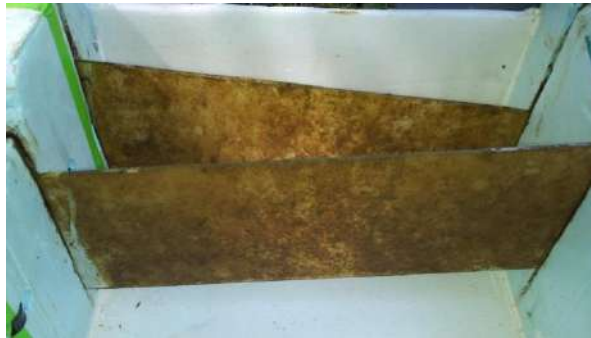
Figure 5. Lames colonisées après 1 mois d'immersion sur une station de la Sélune
