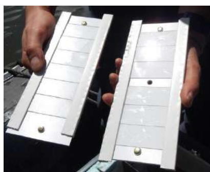
Figure 14. Supports avec lames en verre posés dans le lit des affluents.
