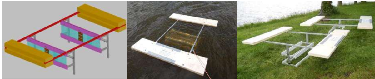
Figure 6. Système de radeau pour les stations lentiques, avec flotteurs et lames positionnées à 30 cm sous la surface, contenant chacun 2x 9 lames)
