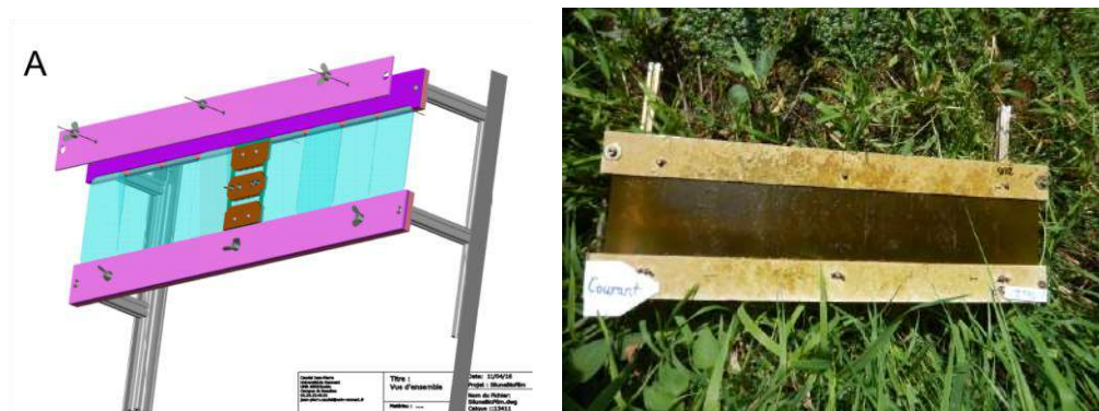
Figure 17. Système de fixation des lames pour les stations lotiques (à gauche) et lames dans leurs supports après colonisation (à droite).
