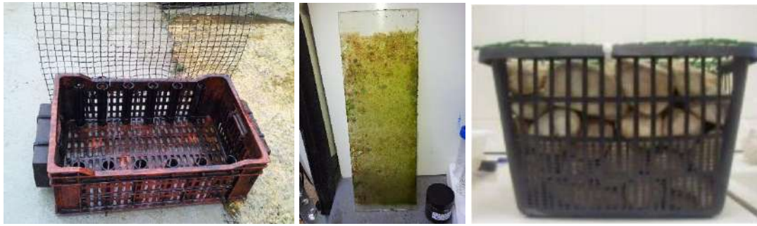
Fig. 2. Photographies d'une cagette pouvant contenir 6 lames de verre pour l'étude du biofilm (à gauche), d'une lame colonisée (au milieu) et d'un substrat artificiel utilisé pour l'échantillonnage d'invertébrés aquatiques (à droite).
