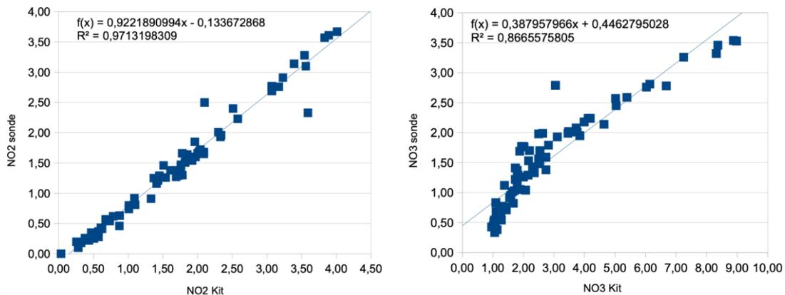
Figure 3 – Courbes de validation sur site  $[\text{NO}_2^-]$  (à gauche) et  $[\text{NO}_3^-]$  (à droite) (concentrations en mg-N/L)
