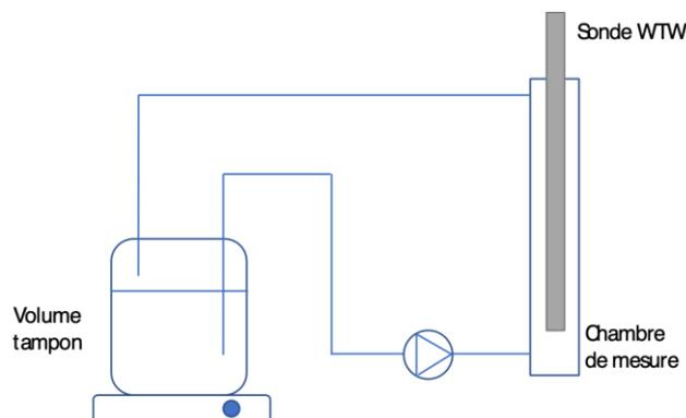
Figure 1 – Dispositif expérimental de calibration en laboratoire
