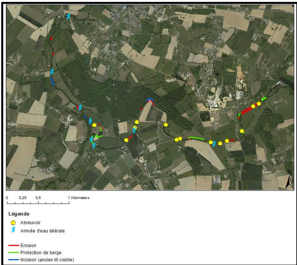
Figure 30 : Cartographie des érosions de berges, des secteurs d'incisions du lit et des abreuvoirs
