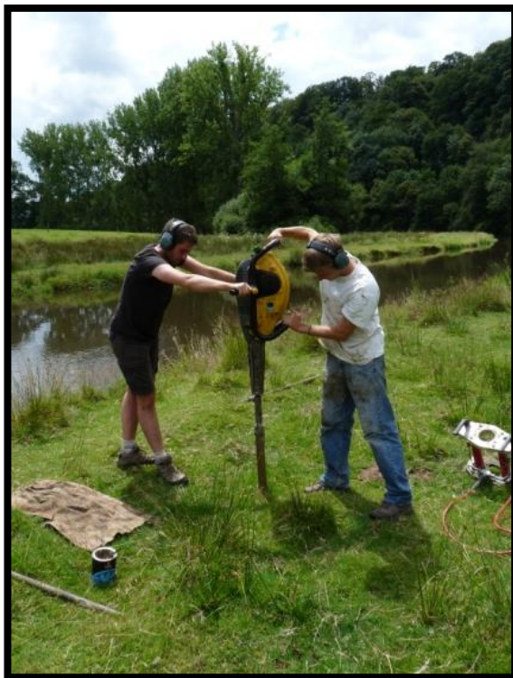
Figure 36 : Carottage au carottier à percussion à Virey (Cliché L. Lespez)
