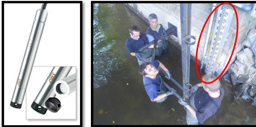
Figure 3 : Capteur de pression (à gauche) et échelle limnimétrique (à droite)
