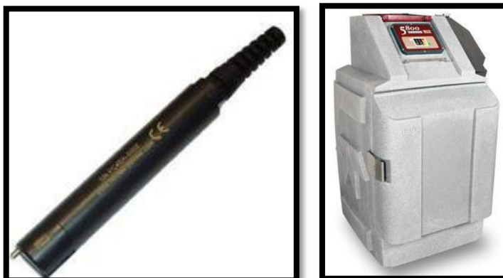
Figure 5 : Sonde de conductivité (à gauche) et Préleveur automatique réfrigéré (à droite)
