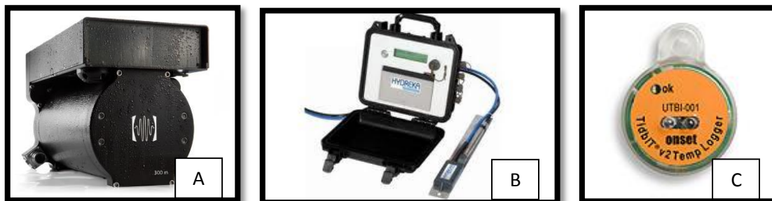
Figure 50 : Dispositifs de suivi installés sur la Sélune. A) La caméra acoustique DIDSON ; B) Courantomètre Hydreka Mainstream IV ; C) Logger de température Tidbit
