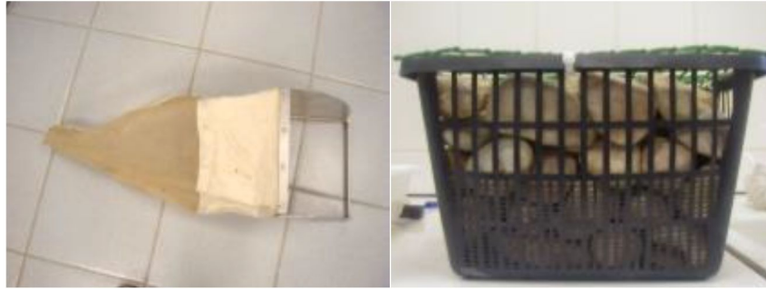
Figure 19. Photographie d'un filet surber (à gauche) et d'un substrat artificiel (à droite) utilisés pour l'échantillonnage d'invertébrés aquatiques sur la Sélune
