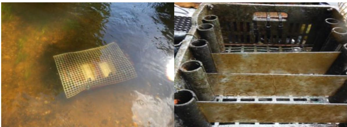
Figure 33. Photographie des substrats artificiels mis en place pour l'étude du biofilm sur la Sélune
